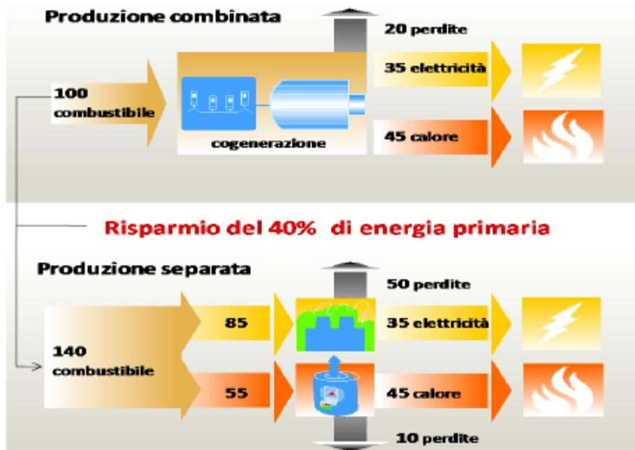
La produzione combinata può incrementare l'efficienza di utilizzo del combustibile fossile ben oltre l'80%; a ciò corrispondono minori costi e minori emissioni di inquinanti e di gas ad effetto serra, rispetto alla produzione separata di elettricità e calore.
